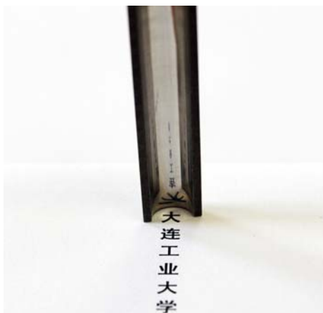
抛光后内孔 (内孔 \Phi 10\text{mm} )
